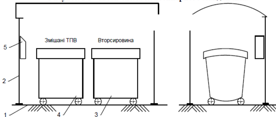
Рис. 3.3- Типове розміщення контейнерів для ПВ (в т.ч. роздільного збирання): 1 - тверде покриття; 2 - розбірний модуль; 3 – контейнер для вторсировини; 4 – контейнер для змішаних ТПВ; 5 – навісний контейнер для ХДС (батареї, тощо).
